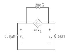
$$\frac{v_{\Delta}}{5000} + \frac{v_{\Delta} - v_o}{20,000} + 2.5 \times 10^{-4} v_{\Delta} = 0$$
